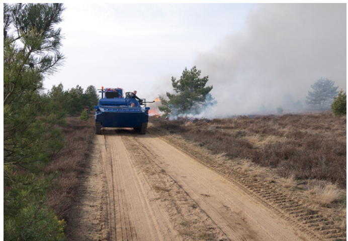
■ Abbildung 16: Einsatz eines Zündpanzers zum Brennen munitionsbelasteter Heideflächen. – A special tank is used to set fire to ammunition-charged heath areas.
